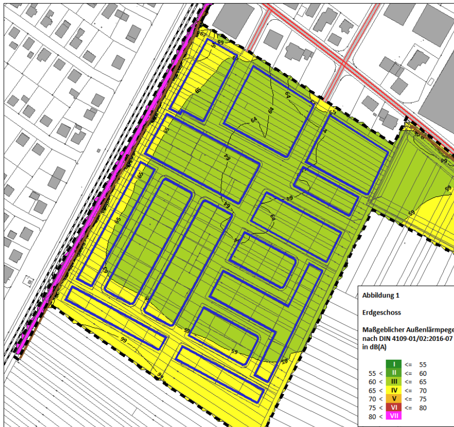
Abbildung 1 Schallschutzmaßnahme SM 3, Erdgeschoss, Büro Kohnen, 06.08.2021
